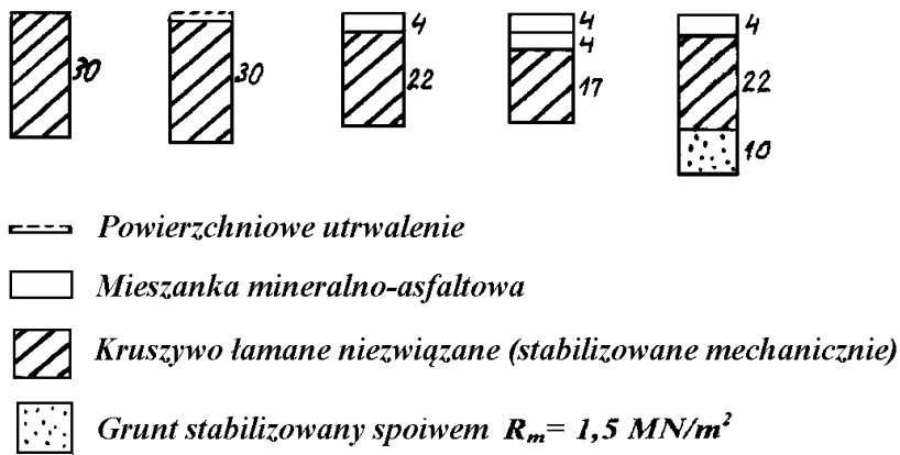
Rys. 4. Przyk6adowe wybrane konstrukcje nawierzchni utwardzonego pobocza z kruszywa 6amanego niezwi6azanego
